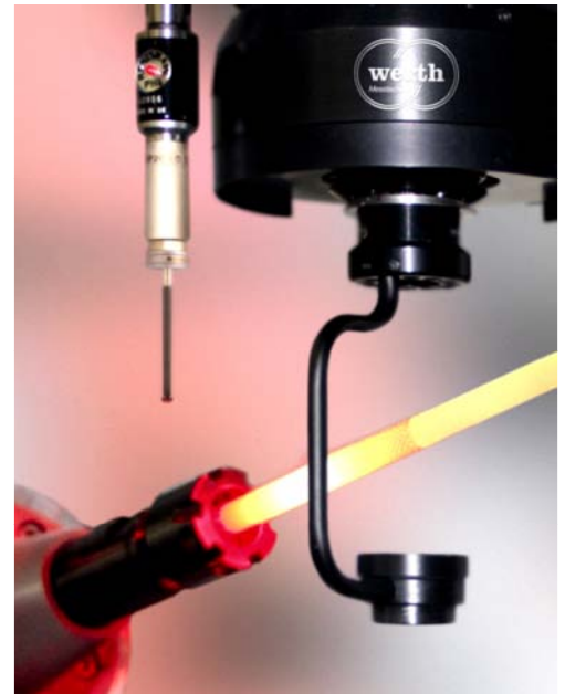
Um die feinen Strukturen von Stents messen zu können, werden sie auf spezielle Dorne aufgezogen. Bild: Werth Messtechnik GmbH
